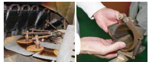
充填・焼成された生地が金型に巻きつくことで、コーンの形になる
